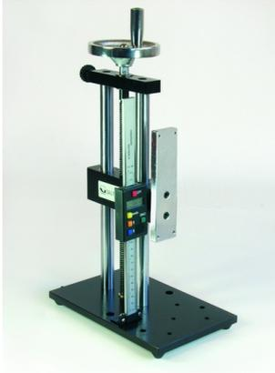
Prüfstand für hochgenaue Kraftmessungen, auch mit Längenmessung,
