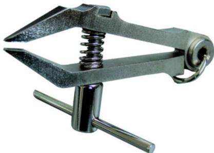
AC 09 Greifklammer-Aufsatz für Einsteck- und Auszugstests bis 5 kN (2 Stück)
